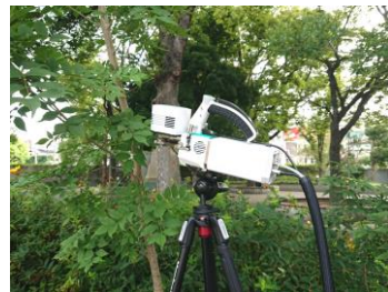
LI-6800での光合成蒸散測定のようす
