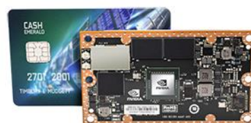
図. 小型スパコン(NVidia JETSON)車の自動運転等の開発にも利用
