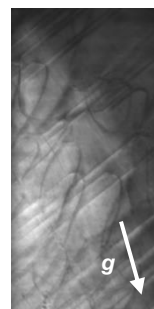
図3. 2\bar{2}4 反射の転位像
