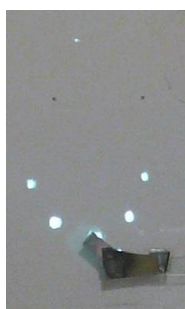
図1. 多波回折条件時の蛍光板
