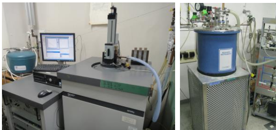
←写真左：磁気特性測定装置、右：強磁場（15テスラ）発生装置
