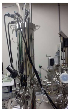
図 1 STM の写真とトンネル電流誘起発光の原理
