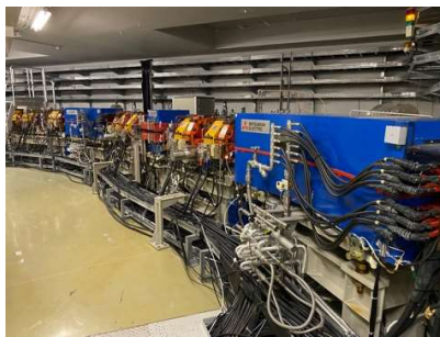
図 2. 電子蓄積リング 高エネルギー電子ビームを周長 120m のリングで周回させて長時間蓄積します。
