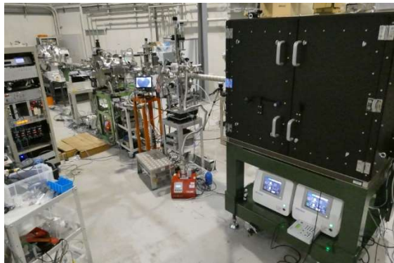
図. 次世代リチウムイオン電池 Si 薄膜電極の充電中測定結果(左図)と現在 BL05 に開発中の高エネルギー X 線用解析装置 (通称ブラックボックス) (右図)。
